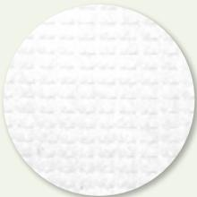
Der unter der Bezeichnung rPET (PET steht für Polyethylenterephthalat) vertriebene Kunststoff wird aus eingesammelten gebrauchten PET - Flaschen hergestellt. Die leeren Flaschen werden gereinigt und zerkleinert, anschließend wird das Material geschmolzen und zu einem Vliesstoff verarbeitet,
