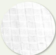
PP (Polypropylen) Woven ist ein aus Polypropylen-Streifen gewebtes (woven) Material. Das Material verfügt über eine hohe Reißkraft, als Tragetaste somit über eine hohe Tragkraft. Wegen seiner Robustheit haben Taschen aus PP Woven eine lange Lebenserwartung, können problemlos recycelt werden und schonen die Umwelt.
